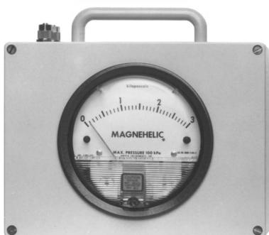
Service-Gehäuse Typ SG-1M Maße: 200 x 135 x 105 mm Schutzart: IP54 Material: ABS-Kunststoff
