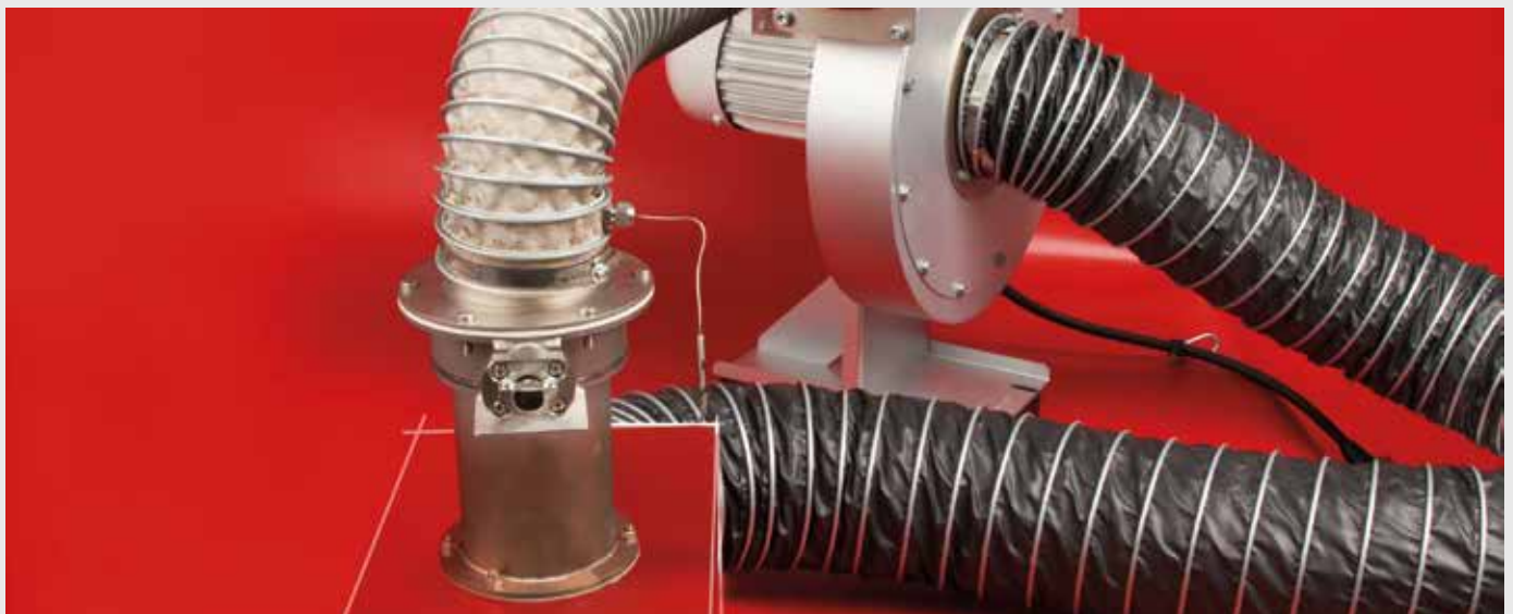
Heissluftsystem zur Heissluftrückführung.
