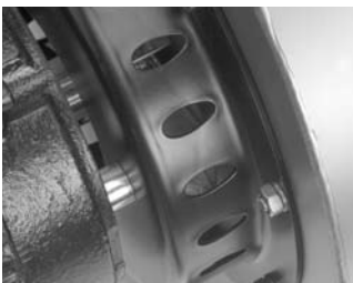
Edelstahl-Ventilator (1.4301) mit stabiler Temperatursperre
