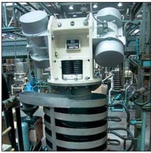
Bild 18 Der obenliegende Antrieb ermöglicht eine sehr geringe Höhe für die Produktaufgabe
