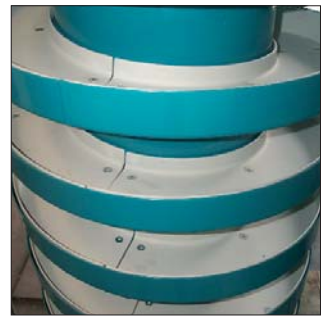
Bild 17 Wendelförderer mit eingeschraubten Schleißschalen
