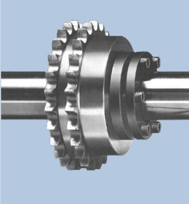
Die ETP-Spannbuchse ist ein hochwertiges Spannelement. Kettenräder, Zahnräder, Hebel und andere Maschinenteile können damit schnell, mühelos und dauerhaft auf Wellen montiert werden. Nuten, Verstiftungen, Gewinde usw. entfallen.
